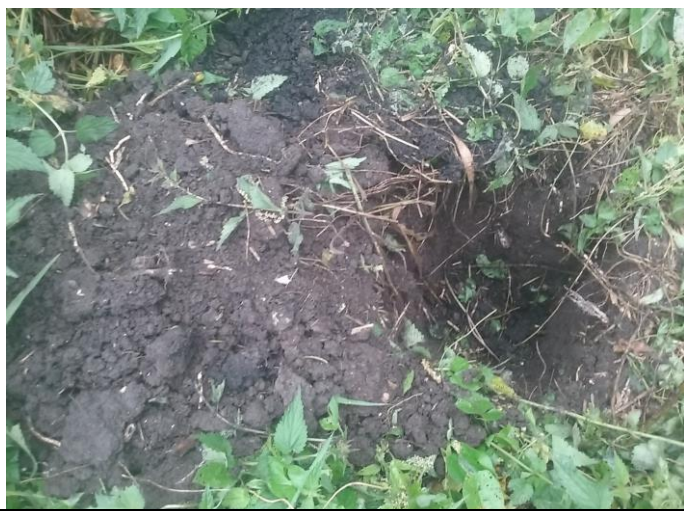
Figuur 4: Asbest graafgat 816, zandlaag met puin-1
