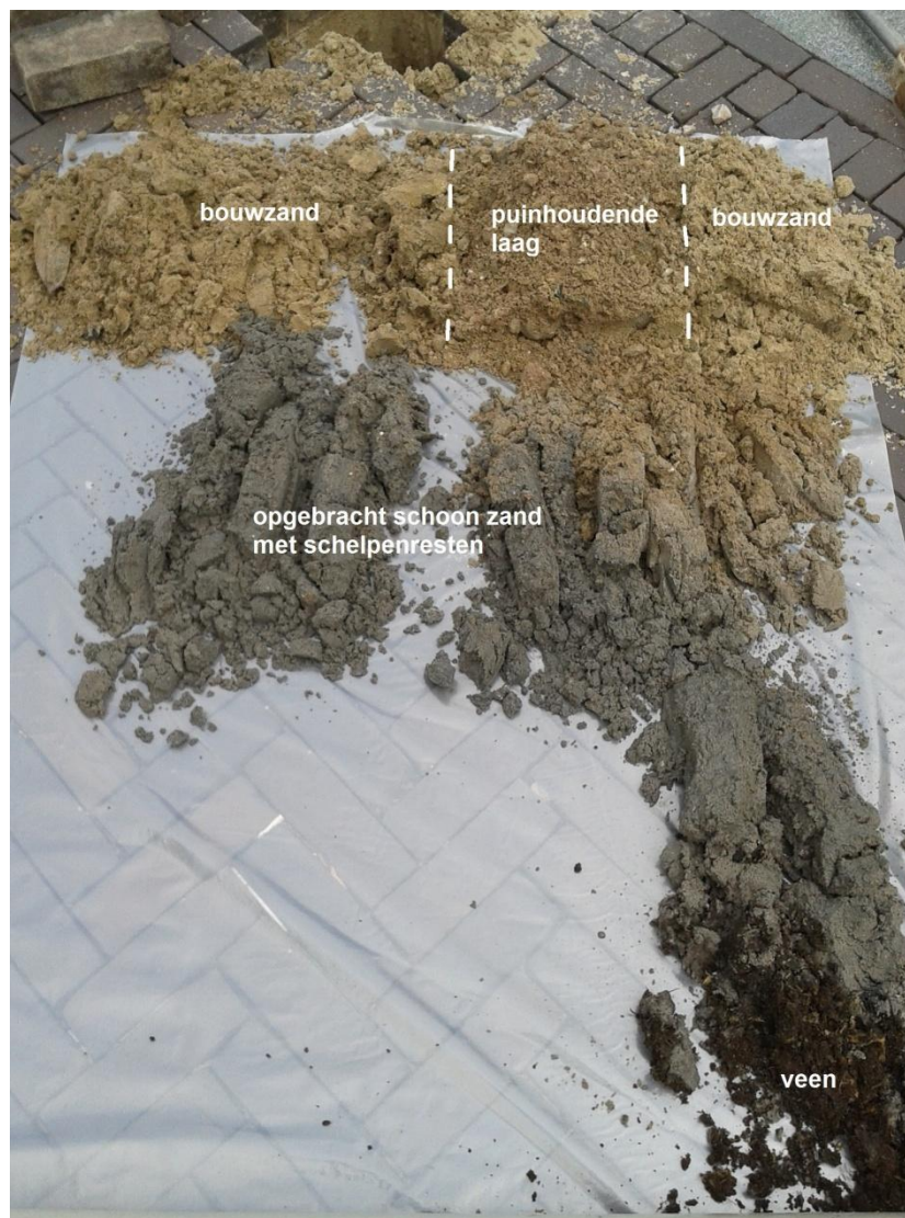
Fig. 3.2: Opgeboorde sediment van boring 6.
