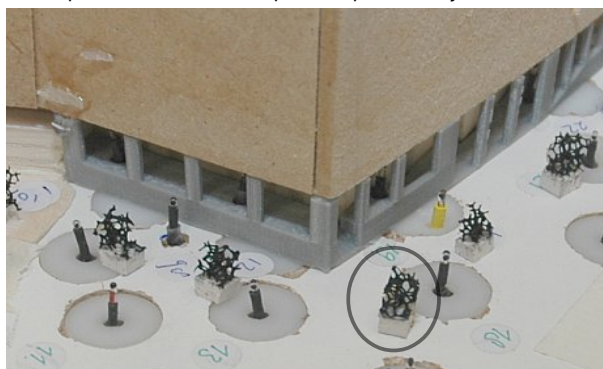
f3.6 Close up boombakken en meetpunten op trottoir bij De Heldin
