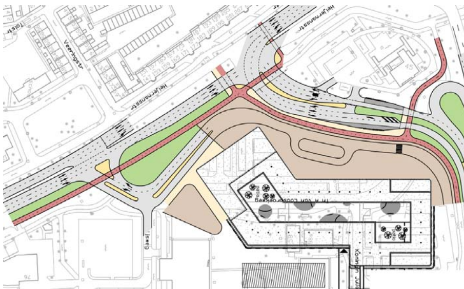
Figuur 1.1: Ontwerp ontsluiting nieuwe ziekenhuis via Heijermansstraat
