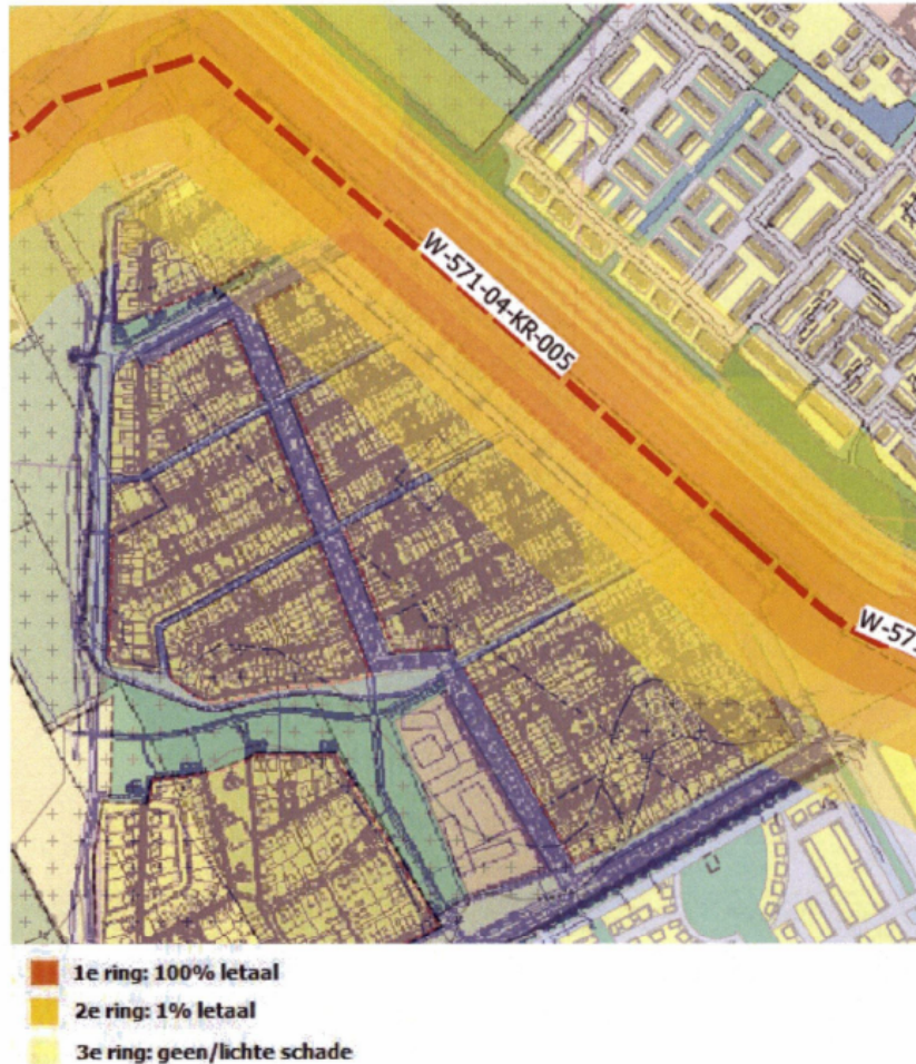
Figuur 2: effectafstanden van fakkelbrand hoge druk aardgasleiding
