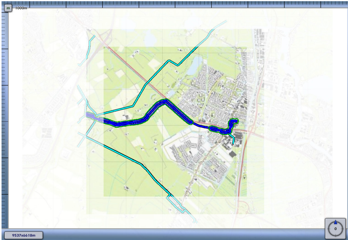
Figuur 3.1 Plaatsgebonden risico voor W-571-04 van N.V. Nederlandse Gasunie
