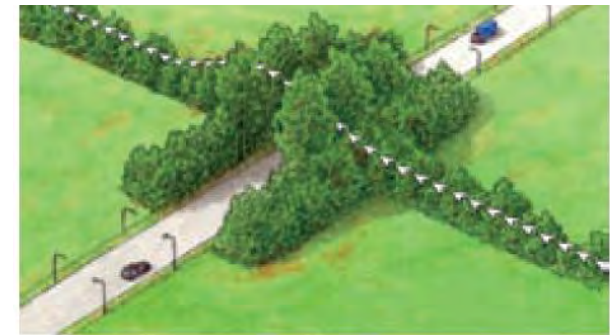
Figuur 23 Voorbeeld van een hopover. Beplanting schermt verlichting af en zorgt ervoor dat vleermuizen hoog over de weg heen vliegen. Hierdoor worden verkeersslachtoffers voorkomen.
