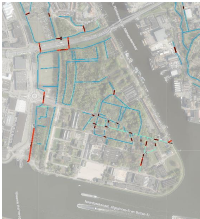
Figuur 6.2: Watersysteem Hembrugterrein (waarbij: blauw staat voor waterlopen en waterhoudende greppels en rood voor kunstwerken ten dienste van de waterhuishouding (duikers, dammen, gemalen, buizen, etc.))
