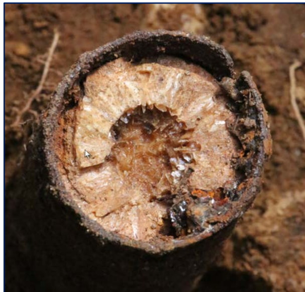
Afbeelding 6: Kristalvorming in springstof. Bron: Leemans Speciaalwerken, Hoog Soeren 2016.
