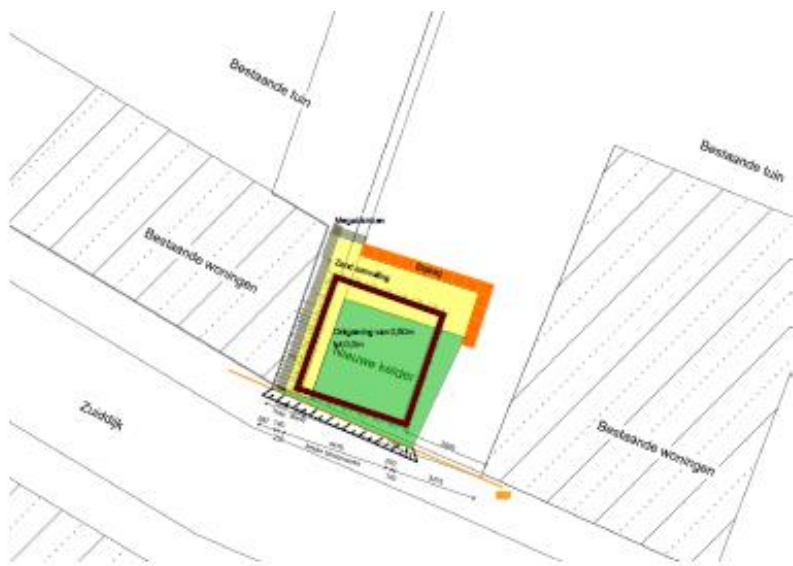
Figuur 13 uitsnede memo grondkering situatie opstelling kelderwanden afzinkkelder van woning aan de Zuiddijk 110 Zaandam met in oranje de 3kv kabel in de stoep.
