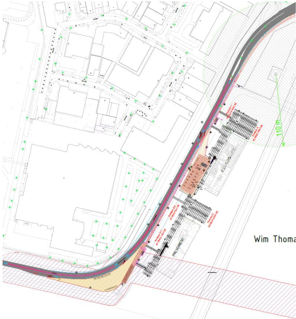
Afbeelding 3.2 Beoogde ligging barges aan de Gerrit Bolkade
