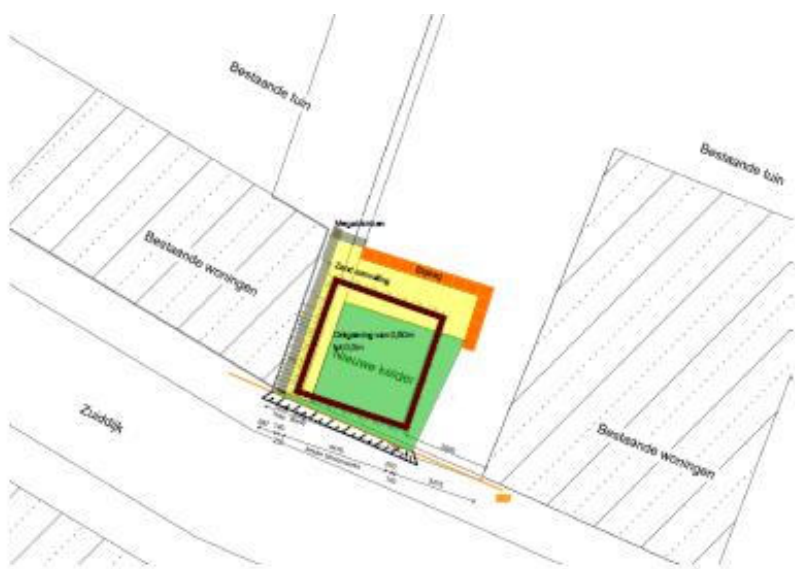
Figuur 13 uitsnede memo grondkering situatie opstelling kelderwanden afzinkkelder van woning aan de Zuidoost 110 Zaandam met in oranje de 3kv kabel in de stoep.
