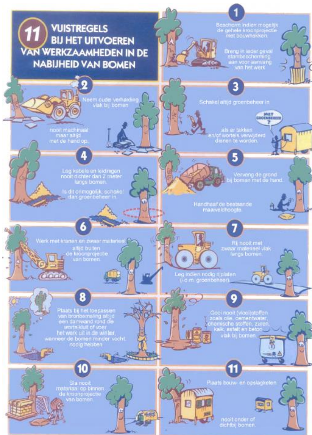
Afbeelding 4.3 Vuistregels bij het uitvoeren van werkzaamheden in de nabijheid van bomen (Bron: Pius Floris)
