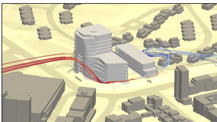
Figuur 5.3: Schematische windstromingen rondom vrijstaande hoogbouw (links) en met gebruik van stromingslijnen voor WNW-richting (rechts)
