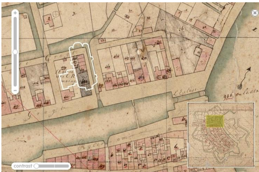
Afbeelding 4 – circa 1825, uitsnede uit de kadastrale minuut. Op de kaart is de huidige contour van de kerk geprojecteerd. Te zien is dat de rechter zijgevel en de achtergevel zijn gefundeerd op de oude Achterherengracht en de watergang die in verbinding stond met de Herengracht. Waarschijnlijk heeft deze omstandigheid te maken met de huidige funderingsproblemen (afbeelding: watwaswaar.nl).
