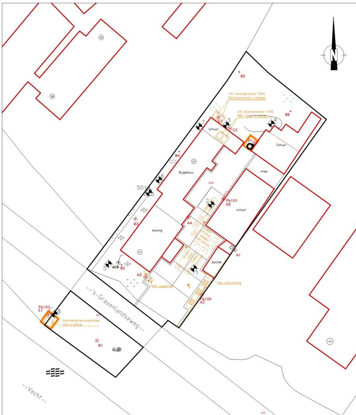
Figuur 5 Situatiekening Boorlocaties
