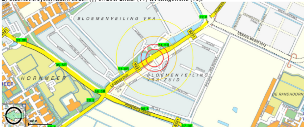
Afbeelding: gevolgen van een (warme) BLEVE met een tankwagen met 48 m 3 LPG en een blootstellingsduur van 12 seconden, slachtoffersystematiek (†= aantal doden, T1-T3 = zwaar tot lichtgewond)
