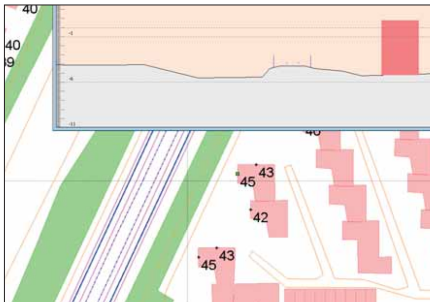
Figuur 9: schermafdruck uit geluidsmodel met dwarsprofiel (indicatief 1m scherm)
