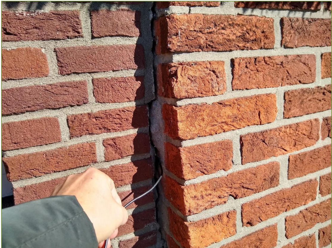
Foto 8: onderzoek met een endoscoop in kieren en gaten.
