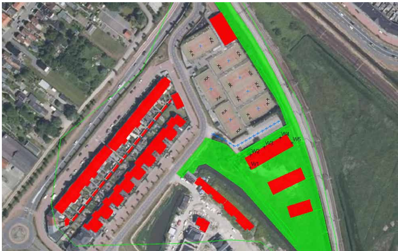
Figuur 2: akoestisch rekenmodel met waarneempunten
