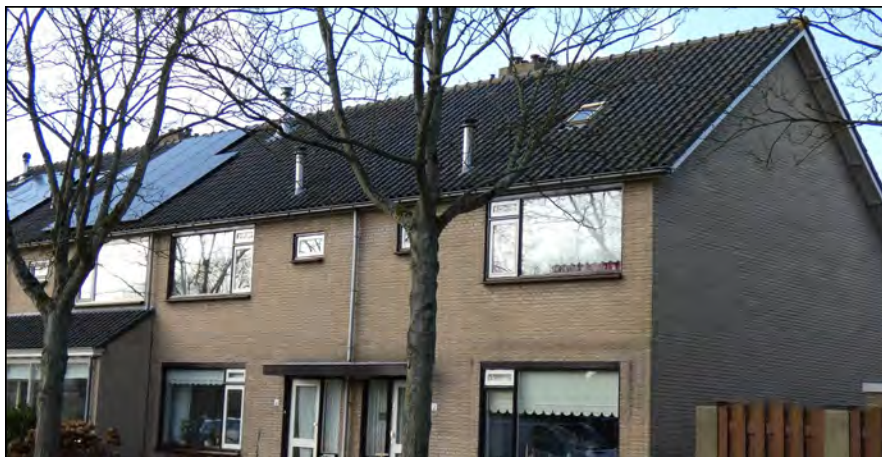
Figuur: de woningen direct rond het plangebied hebben dakpannen en open stootvoegen en zijn geschikt voor huismus, gierzwaluw en vleermuizen.
