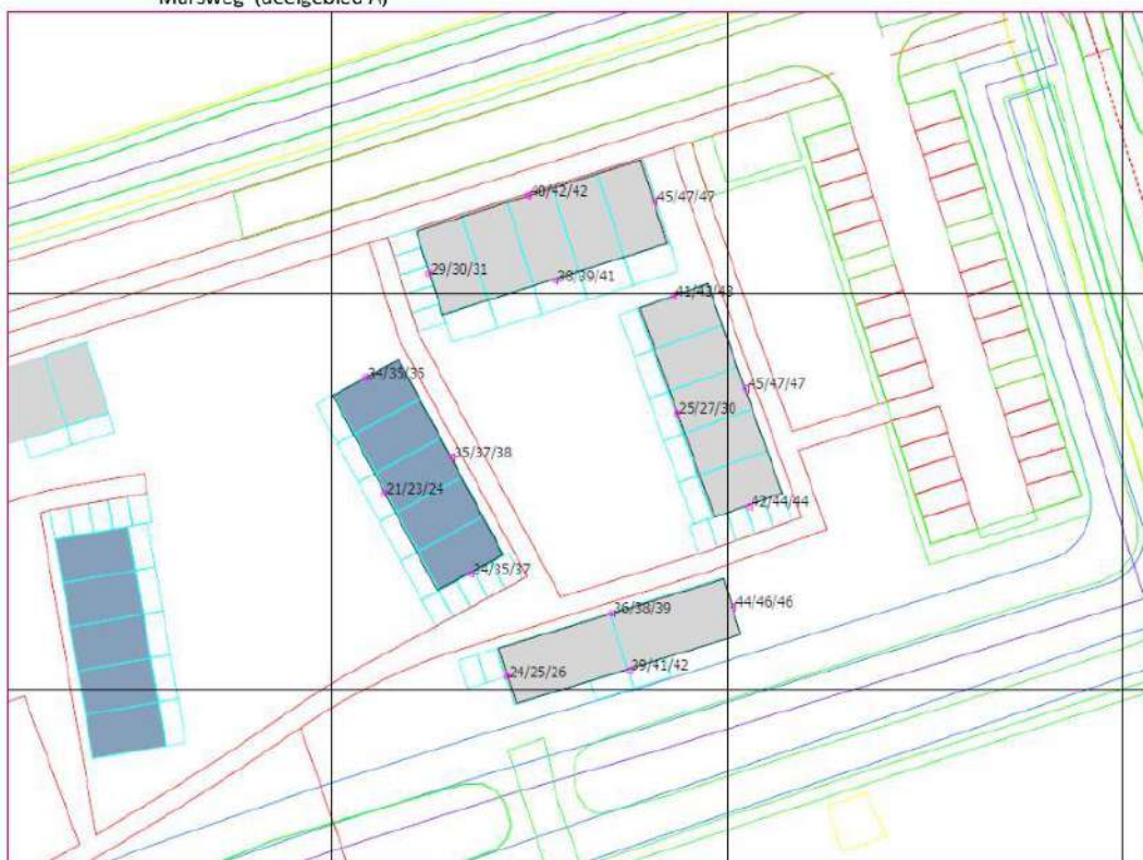
Figuur 4: berekende geluidbelasting L_{den} in dB (inclusief 5 dB aftrek o.b.v. artikel 110g Wgh) vanwege de Marsweg (deelgebied A)
