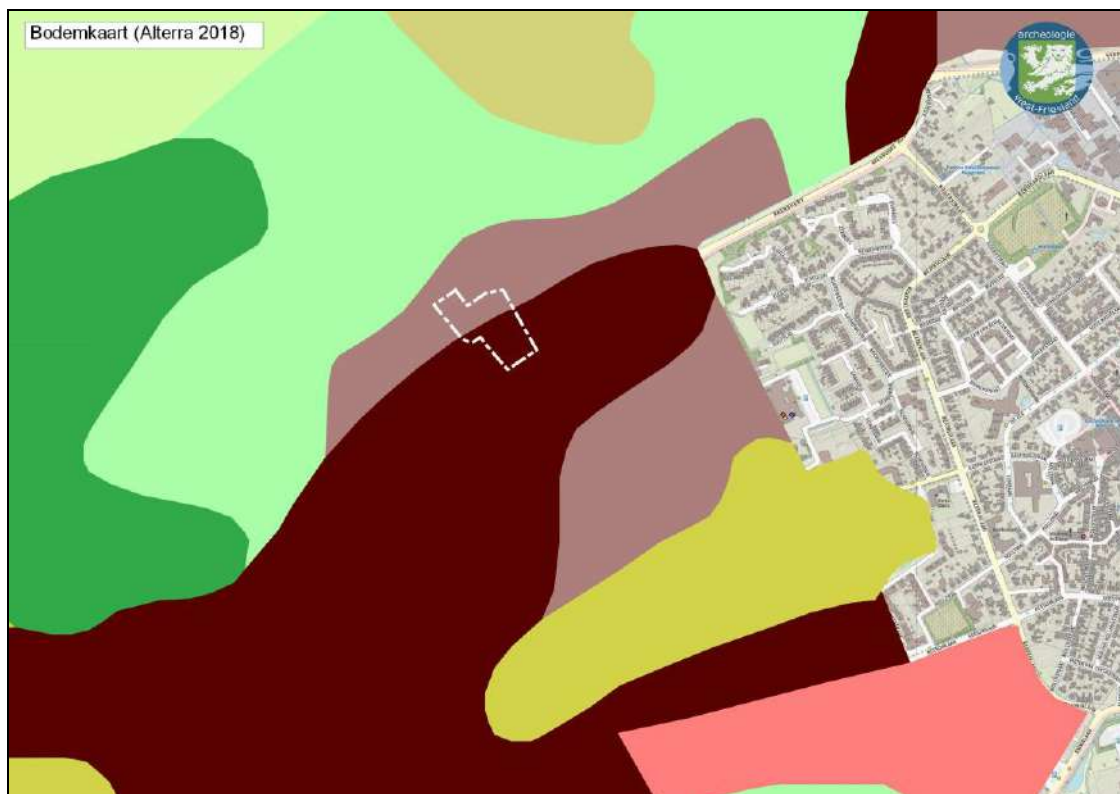
Afbeelding 6. Plangebied (witte stippellijn) op de bodemkaart. Donkerbruin: Hoge bruine enkeerdgronden; lemig fijn zand. Lichtbruin: Laarpodzolgronden; lemig fijn zand. Lichtgroen: Beekeerdgronden; lemig fijn zand. Bron: Alterra 2018.
