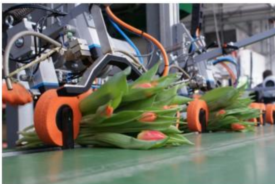
Foto 4. Het maken van bossen gaat volledig automatisch
