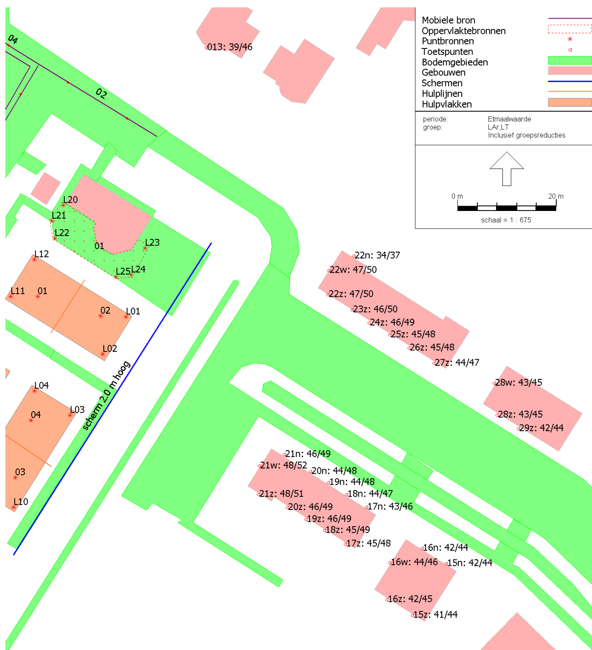
Figuur 2: Berekeningsresultaten LAr,LT etmaal incl. 5 dB toeslag Impulsgeluid, norm LAr,LT 45 dB(A) Variant 2: Maatregel 2.0 m hoog scherm
