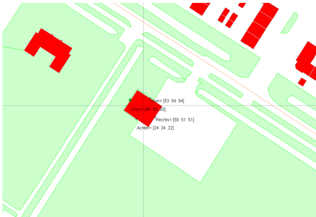
Figuur 6: Overzicht gevelbelasting Lden (dBA) Volleringweg hoogste waarde incl. 5 dB aftrek conform art 110g Wgh
