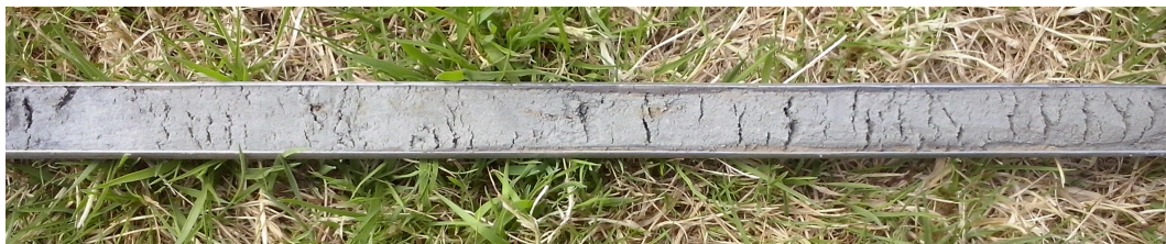
Figuur 6. Waarland, “De oude voetbalvelden”. Foto van het in alle boringen aangetroffen gelaagde kleipakket.
