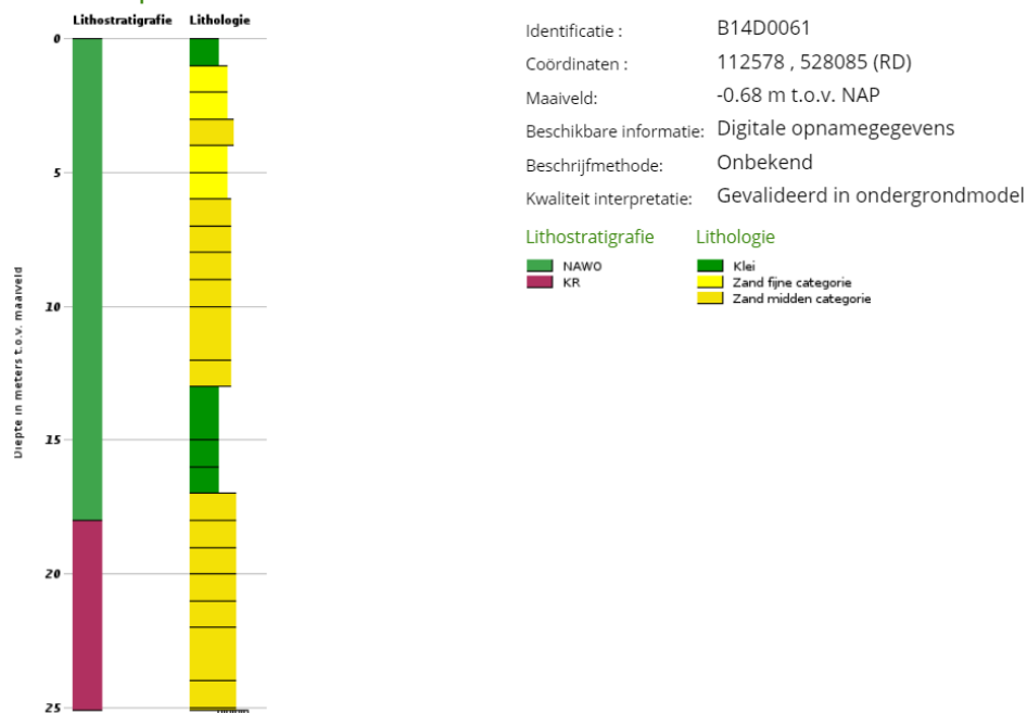
Afbeelding 2.1: Boorbeschrijving boring B14D0061 (Dinoloket)
