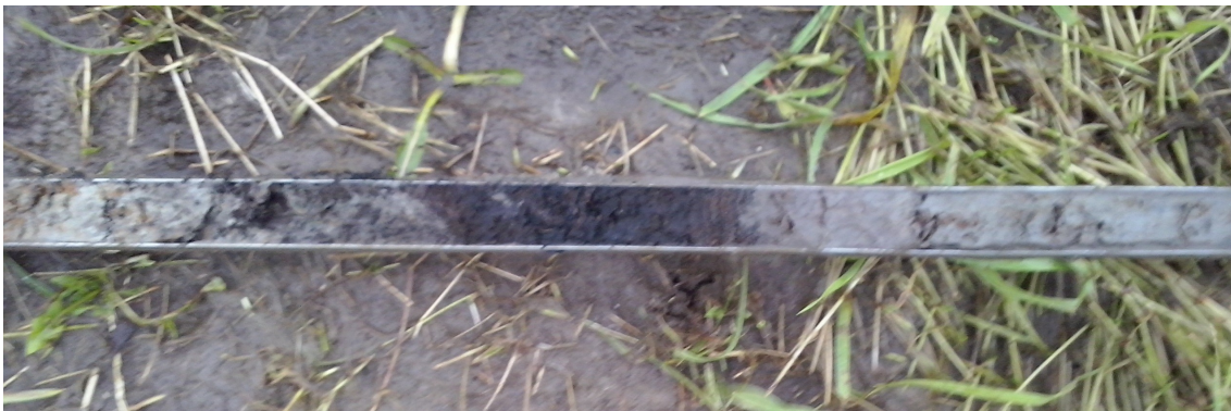
Figuur 6. Schagerbrug, zuidelijke verlengde van P. Ottstraat. Foto van boring 2 met het sterk geërodeerde pakket sterk veraard veen (donkerbruin; midden) met links daarvan klei met daarin brokken losgeslagen veen.
