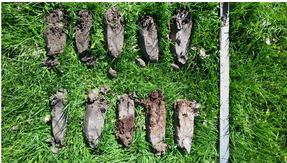
Afbeelding 3.1: bodemprofiel ter plaatse van boring 1 (Foto: Synthebra B.V.).
