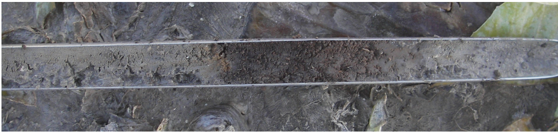
Figuur 5. Warmenhuizen, Heemtweg 5. Veenlaagje (bruin) zoals aangetroffen in boring 2 met daarboven en daaronder matig zandige, zwak humeuze klei.
