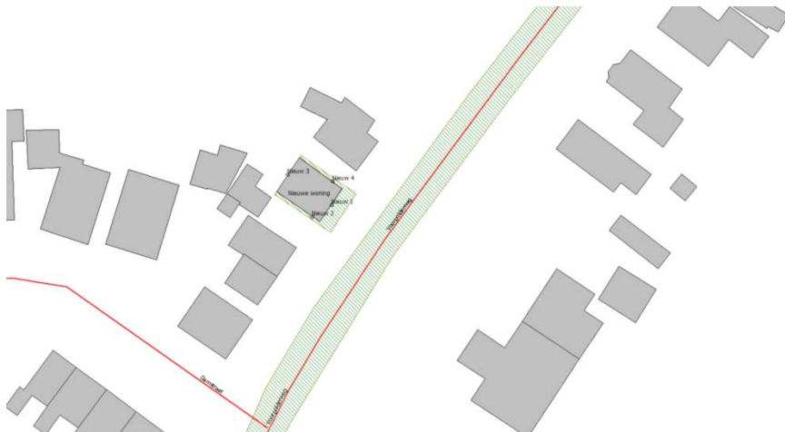
Figuur 2: Plot van het geluidoverdrachtsmodel met vier beoordelingspunten op de gevels van de woning.
