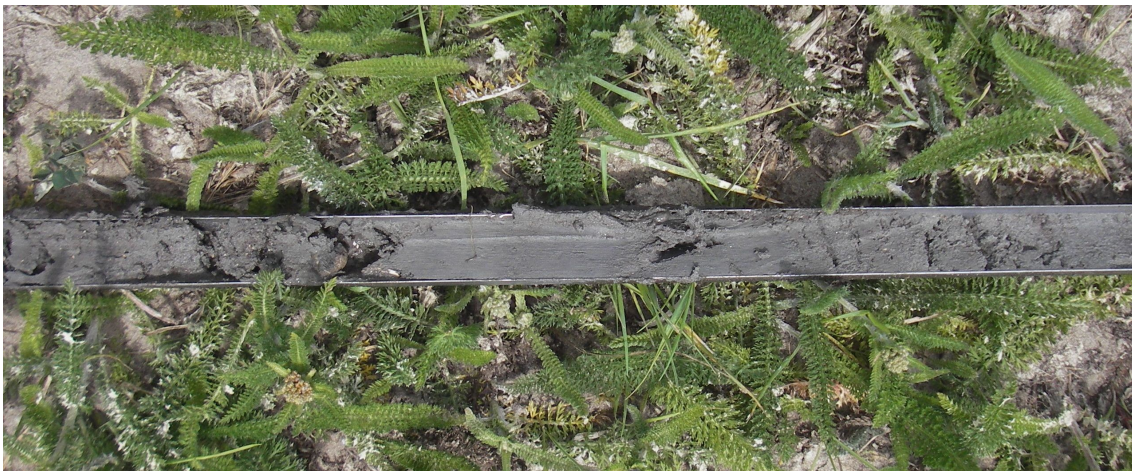
Figuur 6. Stolperophaalbrug, Tankstation. Het onderin alle boringen aangetroffen pakket matig slappe ongeoxideerde klei dat overal in het plangebied doorloopt tot een diepte van tenminste drie meter beneden het maaiveld.
