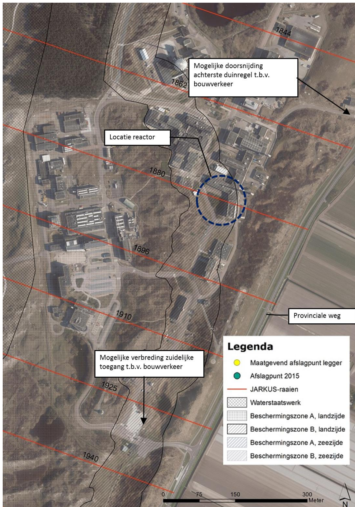
Figuur 16 Detail positie PALLAS-reactor ten opzichte van het waterstaatswerk, inclusief logische posities van een mogelijke doorsnijding met duinregel langs provinciale weg t.b.v. bouwverkeer
