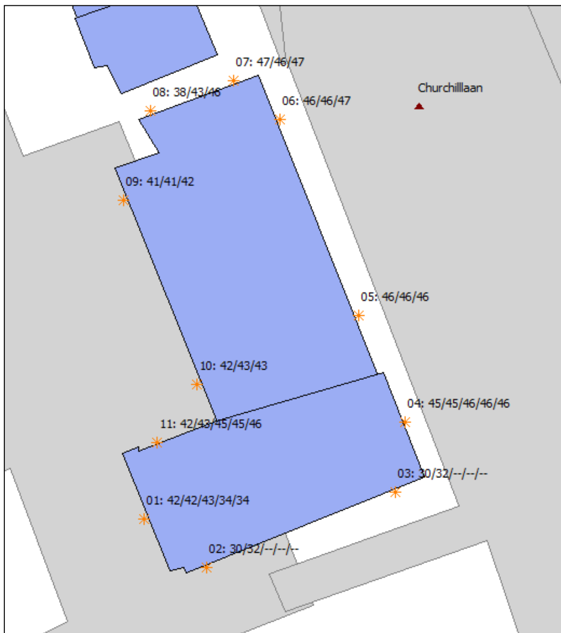
Afbeelding 2: Geluidsbelasting in dB(A) per waarneemhoogte ten gevolge van de spoorlijn Zaandam-Hoorn
