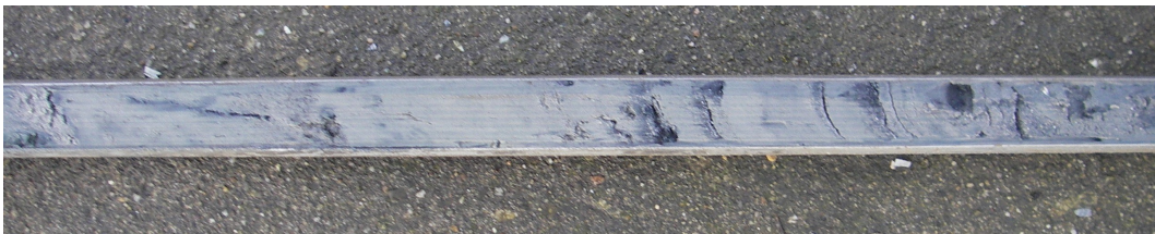
Figuur 6. Purmerend, Westerweg. Links ongerijpte klei met enkele zandlaagjes en geheel rechts, schelphoudend zand.
