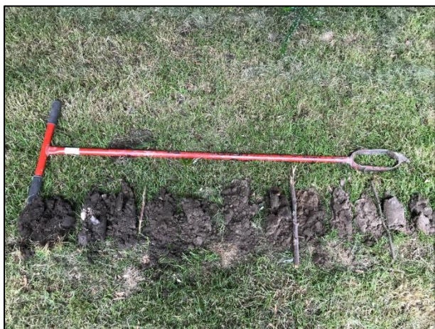
Grondboring bij profielkuil 5
