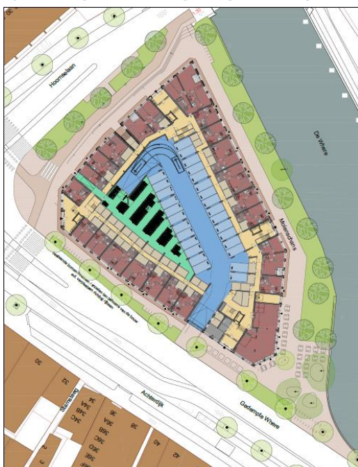
Afbeelding 2.2B Begane grond laag, met parkeergarage (laag 1 van 2)
