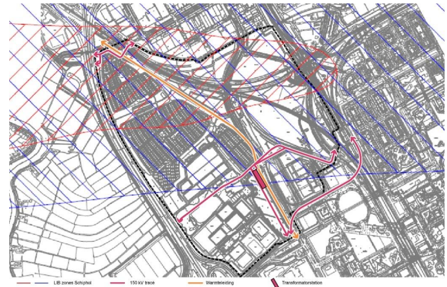
Afb. 2.5 Ligging LIB-zones, 150 kV tracé, transformatorstation en warmteleiding
