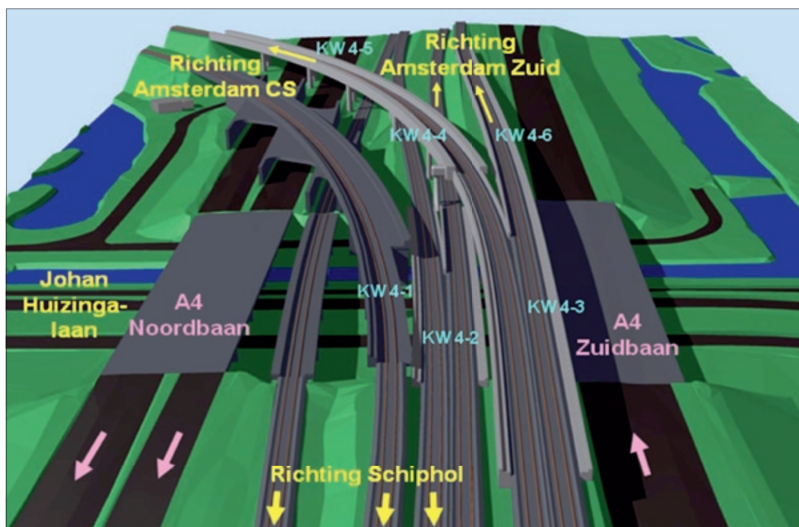
Figuur 5.3.2 Schematische weergave van het kunstwerk J. Huizingalaan / fly-over Riekerpolder
