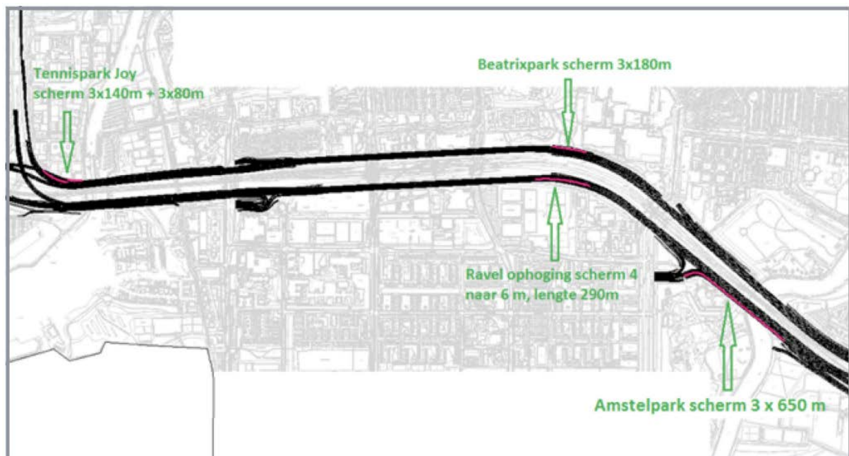
Afbeelding 2: Locaties, lengte en hoogte van de te plaatsen geluidsschermen
