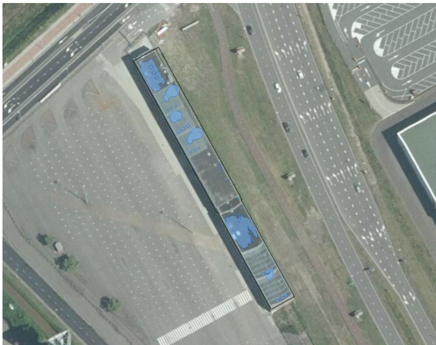
Figuur 5: 100 microtesla grenswaardecontour op 2 meter boven maaiveld.
