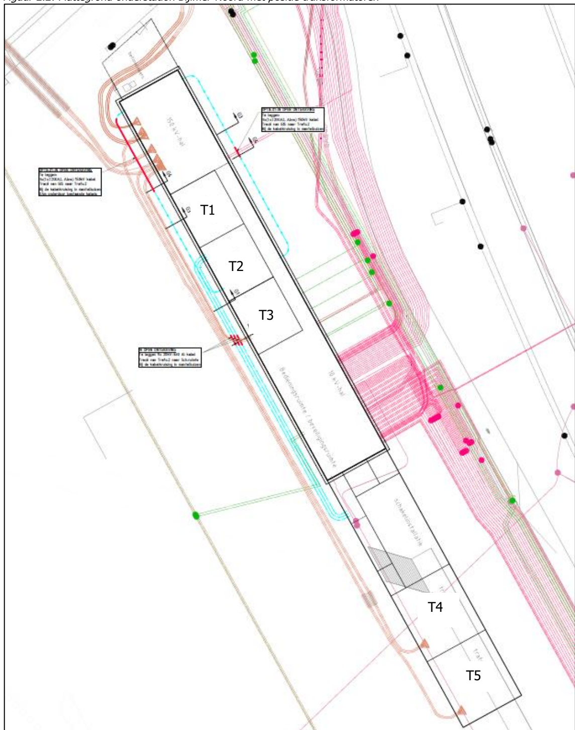
Figuur 2.2: Plattegrond onderstation Bijlmer-Noord met positie transformatoren
