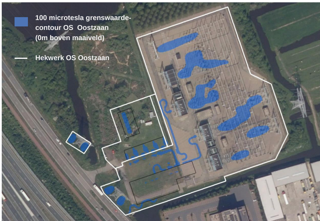
Figuur 1: 100 microtesla magneetveldcontour eindsituatie OS Oostzaan (0 meter boven maaiveld)
