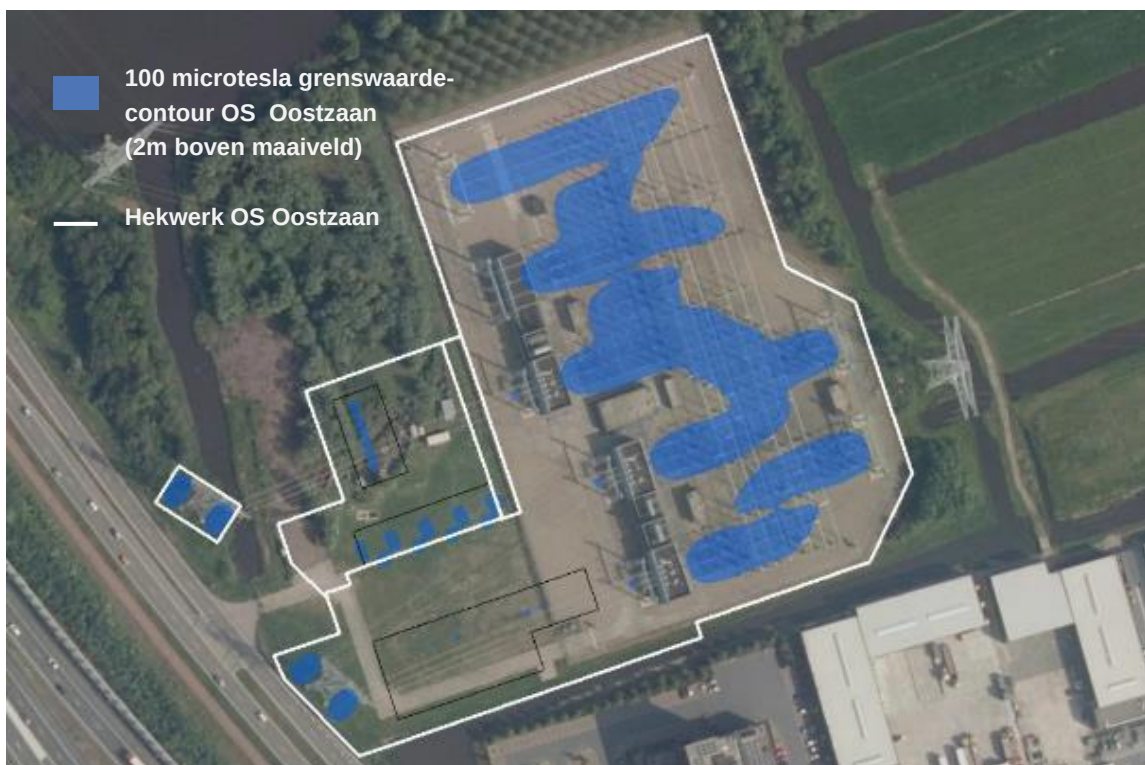
Figuur 2: 100 microtesla magneetveldcontour eindsituatie OS Oostzaan (2 meter boven maaiveld)
