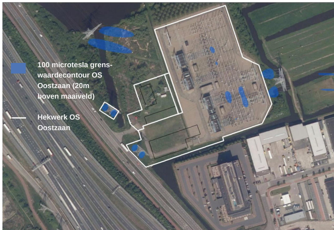
Figuur 5: 100 microtesla magneetveldcontour eindsituatie OS Oostzaan (20 meter boven maaiveld)
