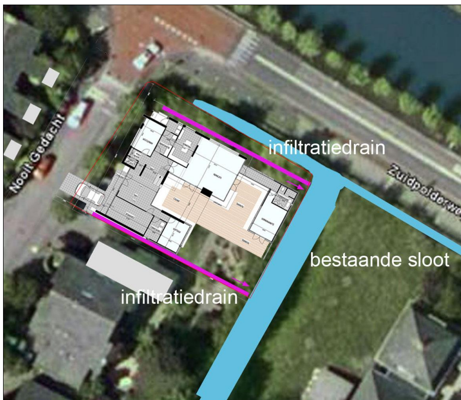
Schets hemelwateropvang en afvoer
