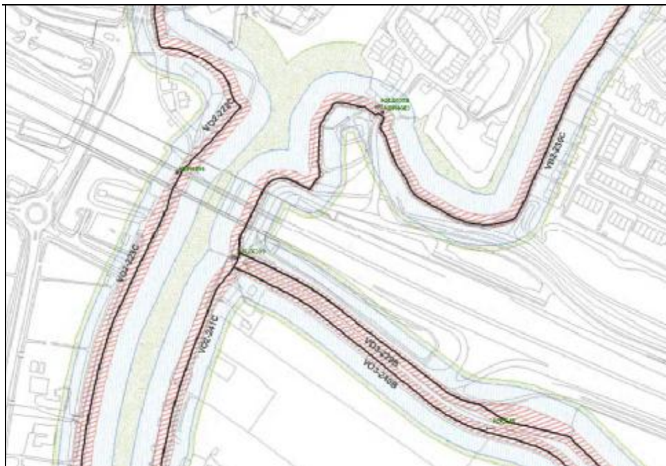
Figuur 2: schets van de bestaande waterkeringszones volgens de legger (waterschap AGV) de kernzone is rood gearceerd, de beschermingszone is blauw (voor dwarsprofiel, zie bijlage 1)
