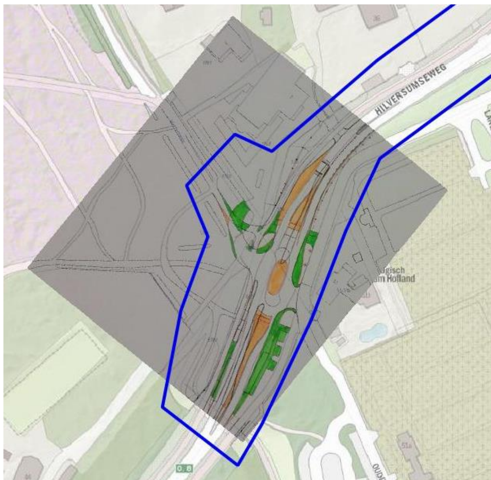
Afbeelding 2 Een deel van het schetsontwerp voor de reconstructie van de kruising N525 met de Oude Postweg/Westerheide. In oranje vervanging van bestaande verharding, groen verlegging kabels en leidingen. Bron: Royal HaskoningDHV.
