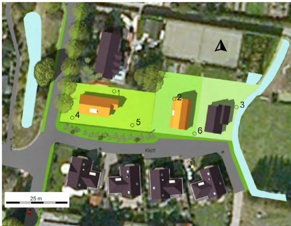
Figuur 8. Sint Pancras, Kieft. Bouwplan met boorpunten. De genummerde punten geven de boorpunten aan. [Bron: BügelHajema Adviseurs bv.]
