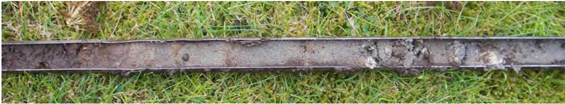
Figuur 9. Sint Pancras, Kieft. Foto van het sterk schelphoudende zand dat onderin alle boringen is aangetroffen.
