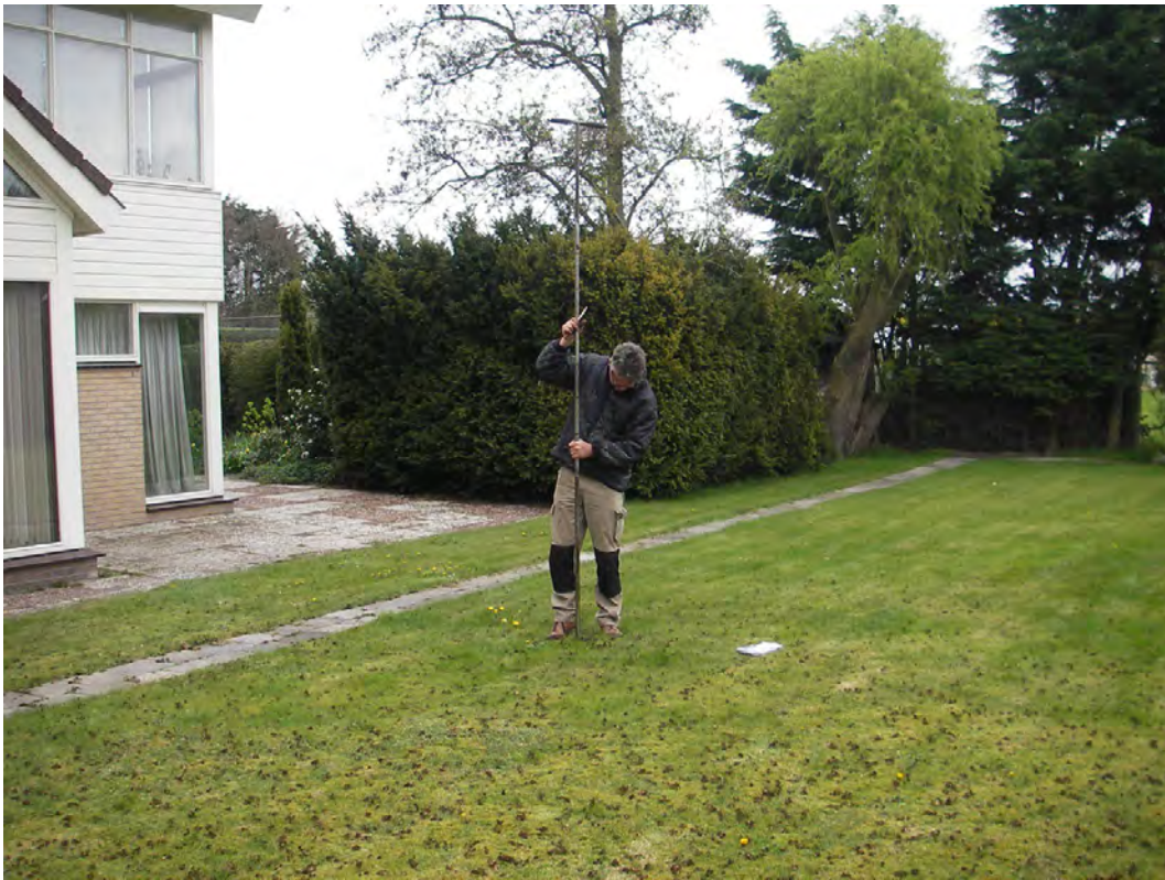
Figuur 7. Sint Pancras, Kieft. Het plaatsen van een gutsboring ter plaatse van boorpunt 2.
