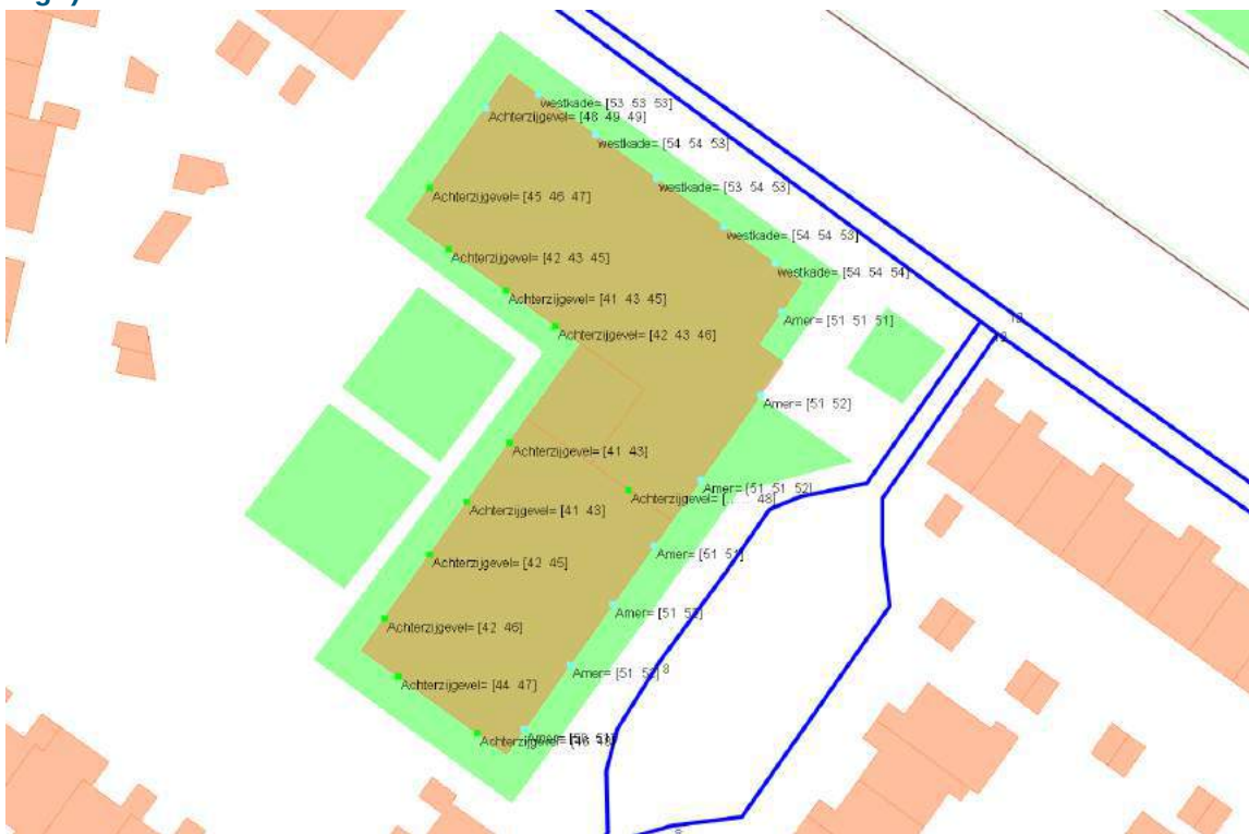
Figuur B3-4 Rekenresultaten cumulatieve geluidbelasting (exclusief 5 dB ex artikel 110g Wgh)
