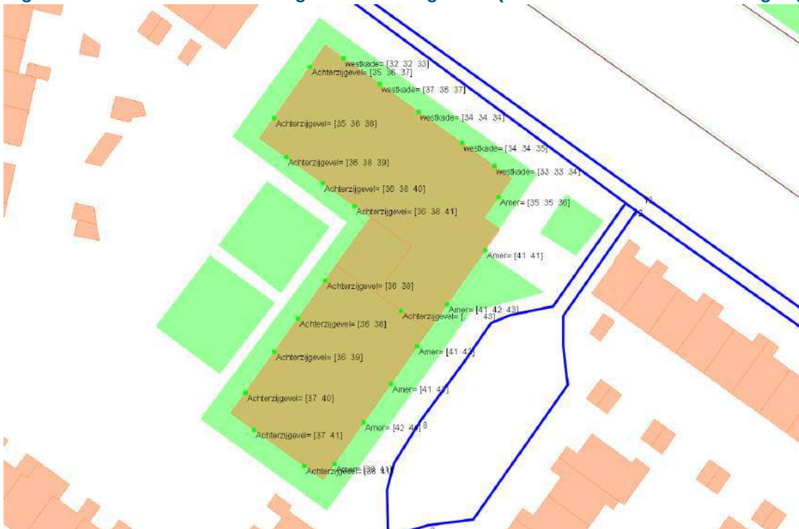
Figuur B3-3 Rekenresultaten geluidbelasting 30 km/u straten (inclusief 5 dB ex artikel 110g Wgh)
