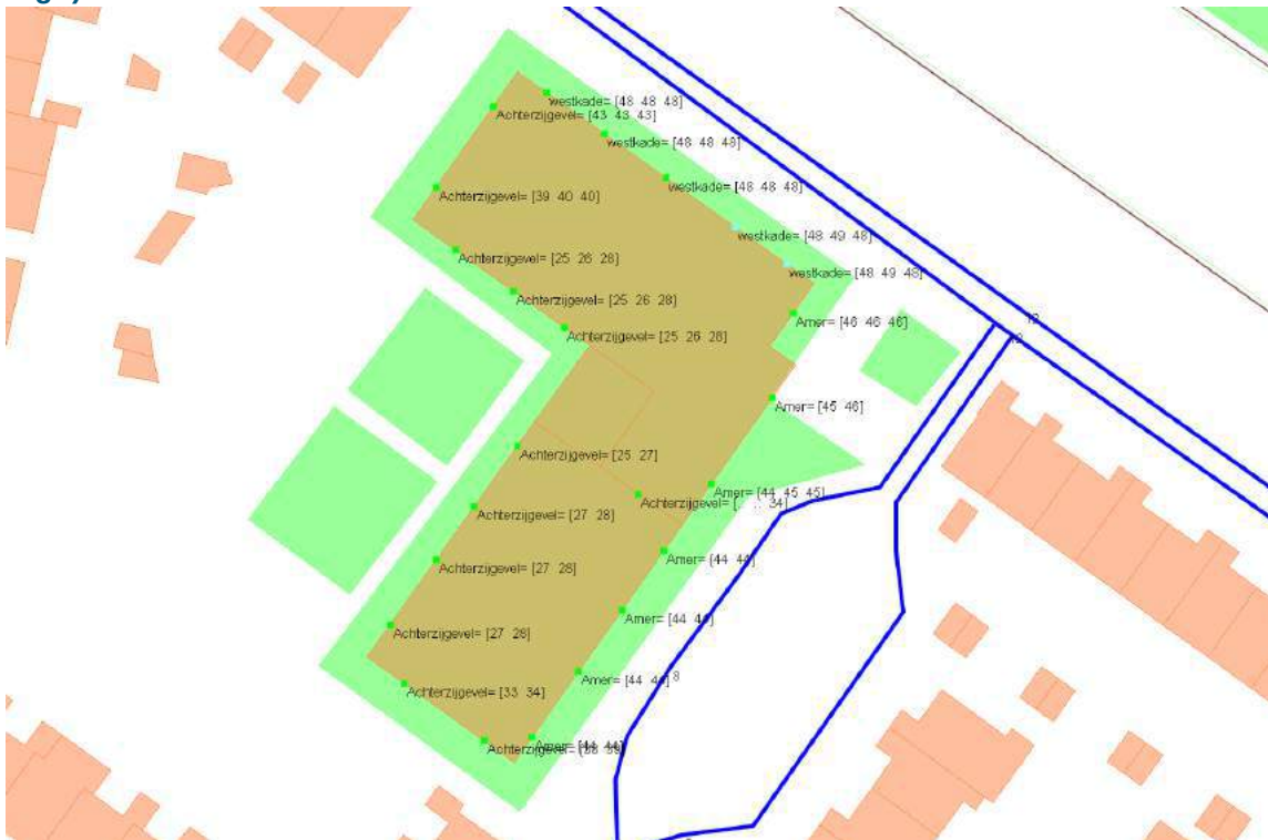
Figuur B3-3 Rekenresultaten geluidbelasting 30 km/u straten (inclusief 5 dB ex artikel 110g Wgh)
