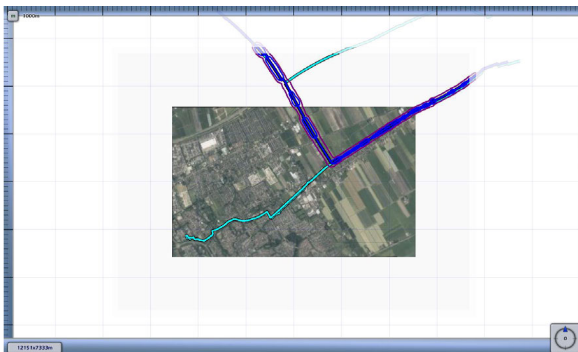
3.4 Figuur 3.4 Plaatsgebonden risico voor 8927_leiding-W-573-09-deel-1 van N.V. Nederlandse Gasunie
