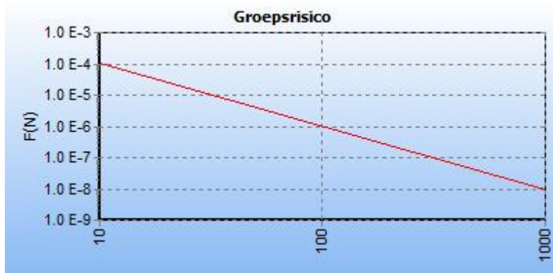
5.7 Figuur 5.7 FN curve voor 8927_leiding-W-573-15-deel-1 van N.V. Nederlandse Gasunie voor de kilometer tussen stationing 910.00 en stationing 1910.00
