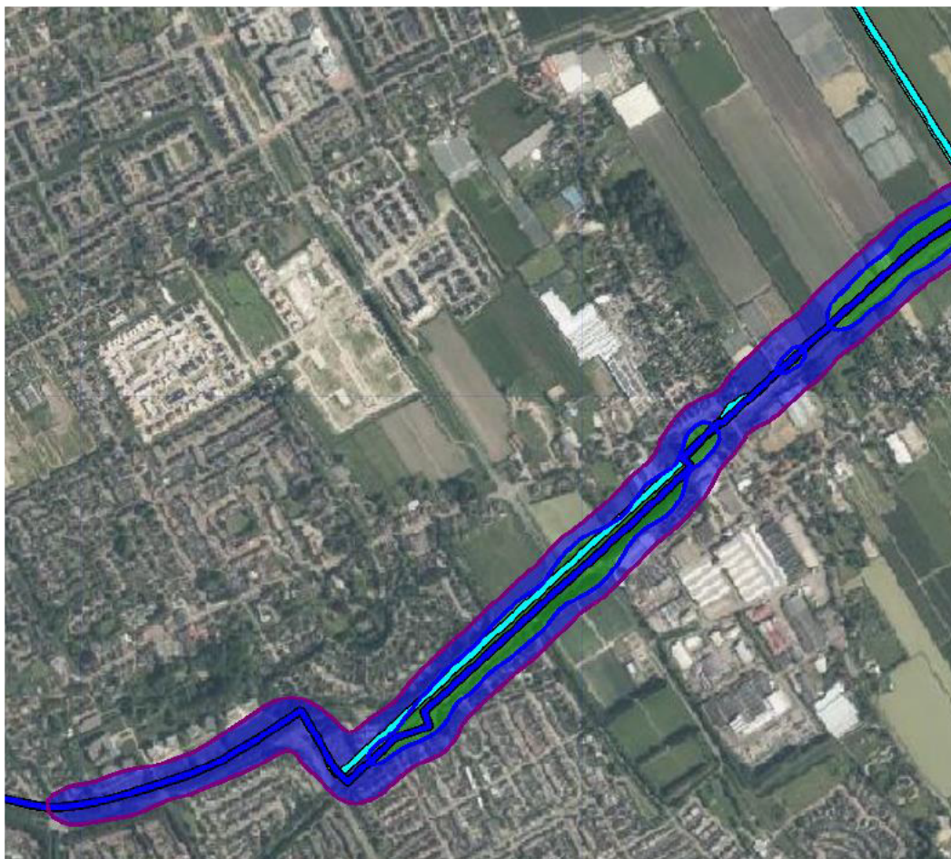
f 6.2 Plaatsgebonden risicocontouren van 10^{-8} (paarse lijn) en 10^{-7} (blauwe lijn) per jaar voor de gasleiding
