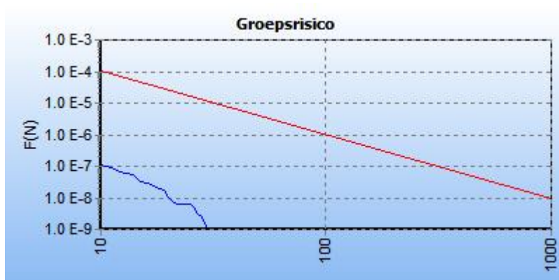
5.5 Figuur 5.5 FN curve voor 8927_leiding-W-573-12-deel-1 van N.V. Nederlandse Gasunie voor de kilometer tussen stationing 750.00 en stationing 1750.00
