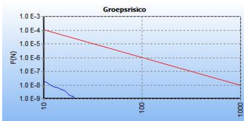
5.5 Figuur 5.5 FN curve voor 8927_leiding-W-573-12-deel-1 van N.V. Nederlandse Gasunie voor de kilometer tussen stationing 750.00 en stationing 1750.00
