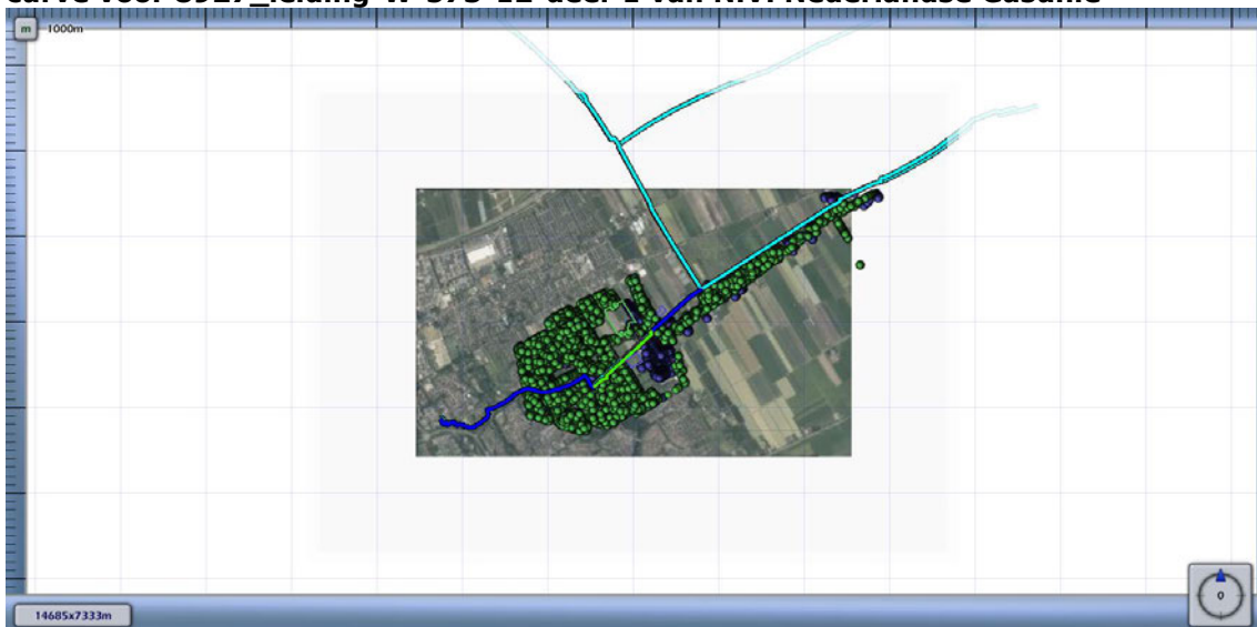
Figuur 4.5 Kilometer leiding behorende bij de maximale overschrijding van de FN-curve voor 8927_leiding-W-573-12-deel-1 van N.V. Nederlandse Gasunie
