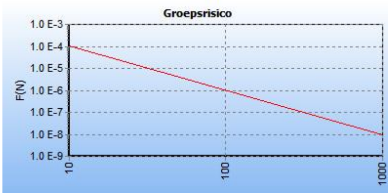
5.2 Figuur 5.2 FN curve voor 8927_leiding-W-573-04-deel-1 van N.V. Nederlandse Gasunie voor de kilometer tussen stationing 0.00 en stationing 1000.00
